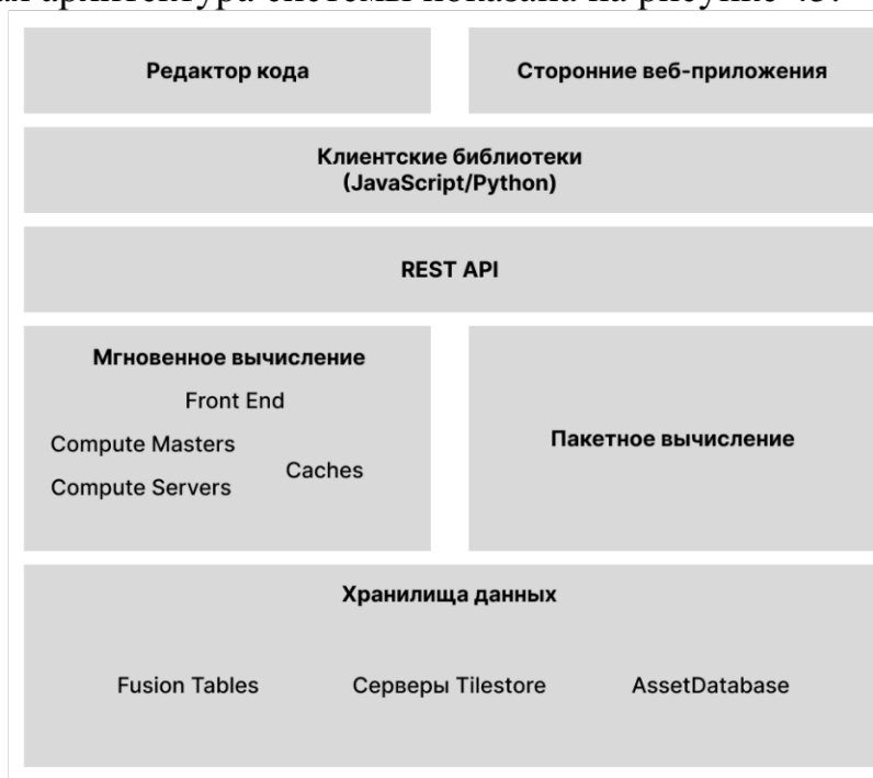
Рисунок 45 – Упрощенная архитектура системы геопортала
